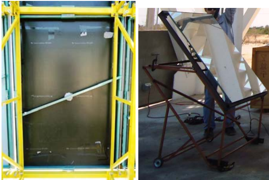
Figure 5.28: Estructura de faceta deformable. Tornillo de ajuste mecánico (izquierda). Marco de sujeción (derecha).
