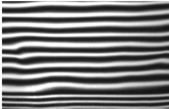
Figure 2.15: Faceta de colector solar plano bajo el análisis de reflexión de franjas.
