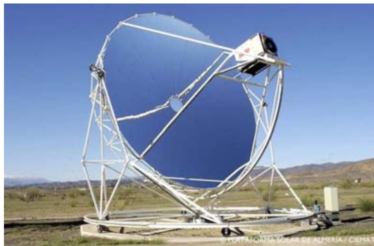
Figure 1.6: Prototipo EURODISH de generador eléctrico de Disco Stirling.
