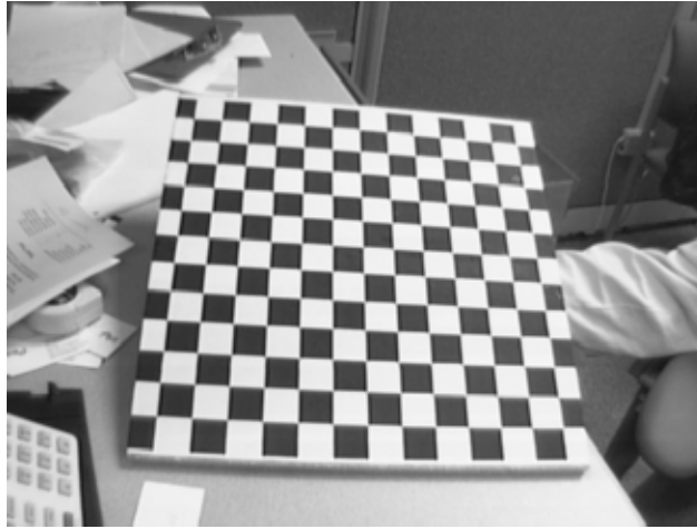
Figure 7.4: Patrón “checkboard” utilizado para la calibración de la cámara.
