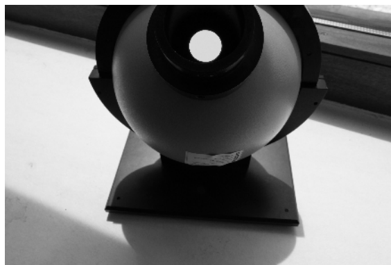
Figure 4.4: Esfera de luz utilizada para mapear el sensor de la CCD de la cámara.
