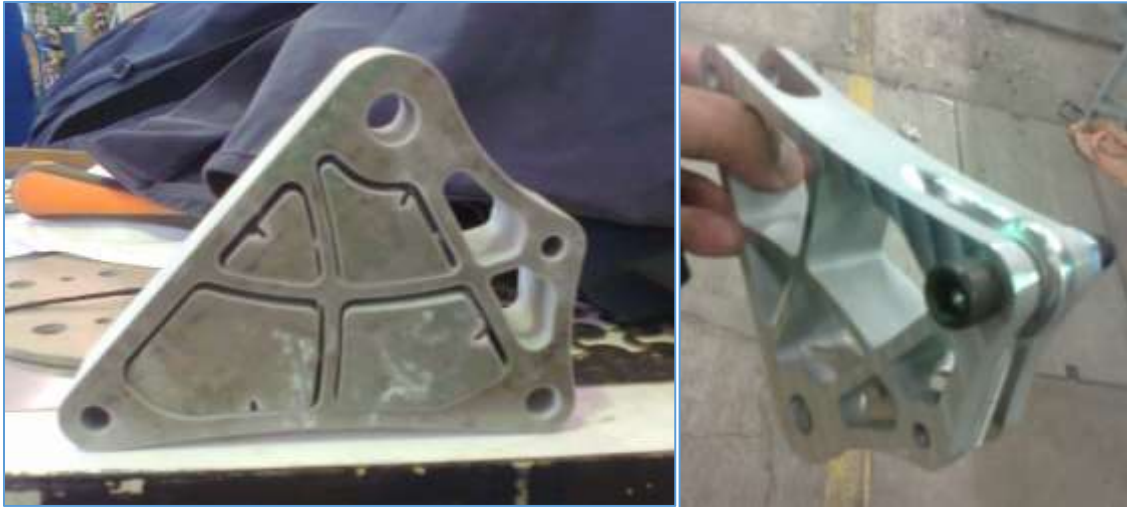
Ilustración 49 – resultado final del proceso de optimización topológica
