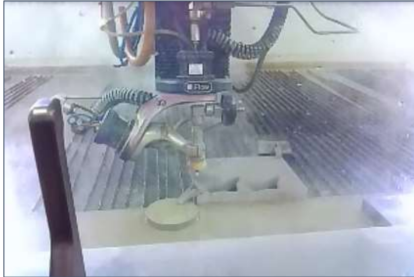
Ilustración 47– Maquinado en cortadora waterjet
