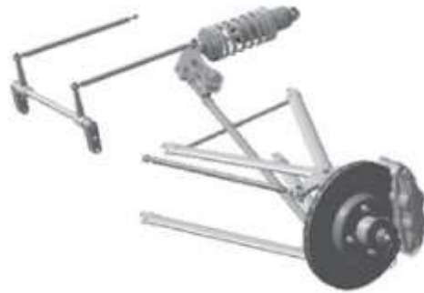
Ilustración 19– Suspensión doble brazo A actuada con push-rod
