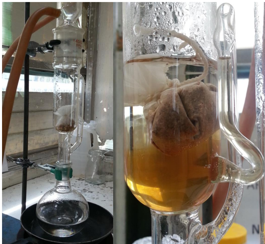
Figura 5.- Obtención de extractos con equipo Soxhlet
