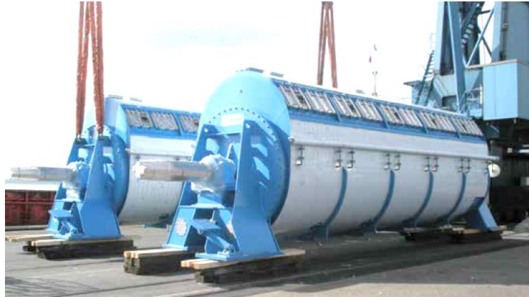
Figura 2.25 Secador de tipo Rotadisc TST. Tomado de HAARSLEV INDUSTRIES.
