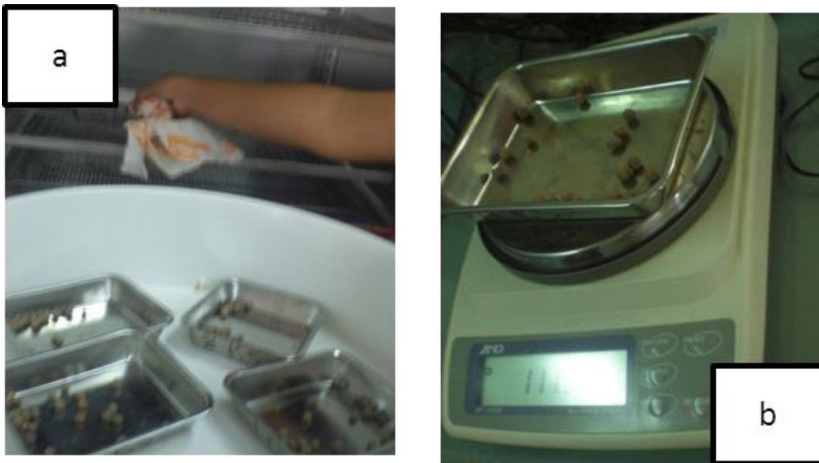
Figura 4. (a) Secado y (b) pesado de las muestras de contenido de humedad.
