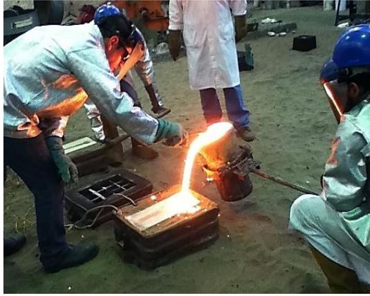
Figura 3.5. Técnica de fusión (vaciado a la olla y a moldes)
