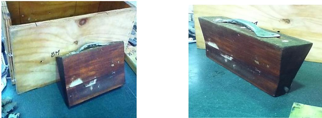
Figura 3.1. Caja de moldeo y modelo de bloque “Y”
