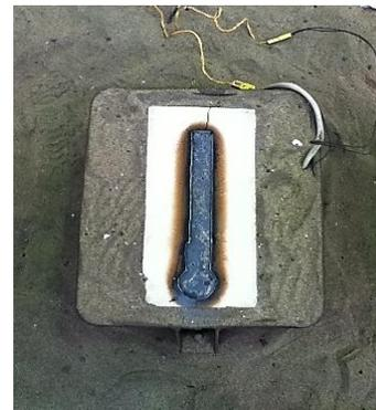
Figura 3.6. Sistema de adquisición conectado a moldes y vista superior del molde con el metal solidificado.
