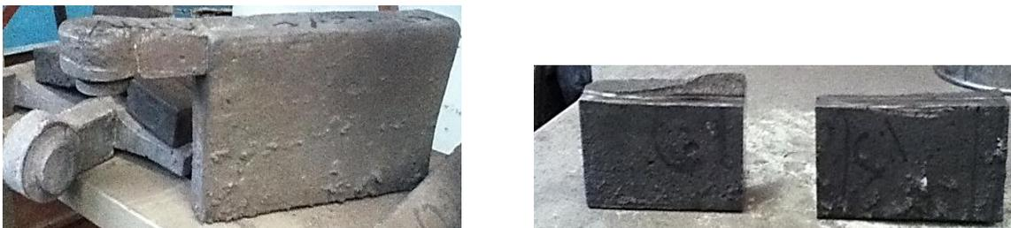
Figura 3.7. Bloque “Y” antes del corte (imagen izq.) y después del corte (imagen der.)
