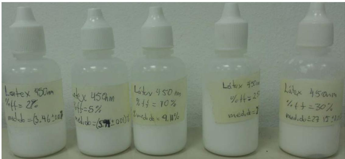
FIGURA 6.13: Coloides de Látex (PMMA) de 450 nm de diámetro a distintas concentraciones.
