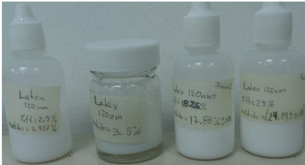
FIGURA 6.12: Coloides de Látex (PMMA) de 120 nm de diámetro a distintas concentraciones.
