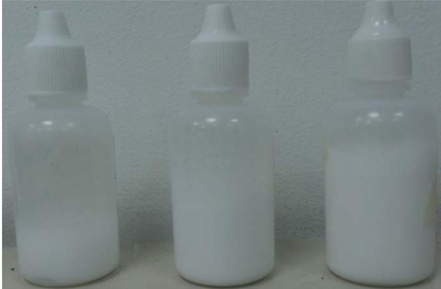
FIGURA 6.14: *Coloides de Dióxido de Titanio de 402 nm de diámetro a distintas concentraciones.*
