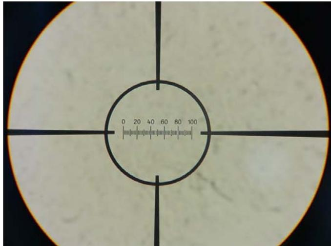
FIGURA 7.11: Escala utilizada para determinar el tamaño en el microscopio óptico, cada marca corresponden a  $2\mu\text{m}$ .
