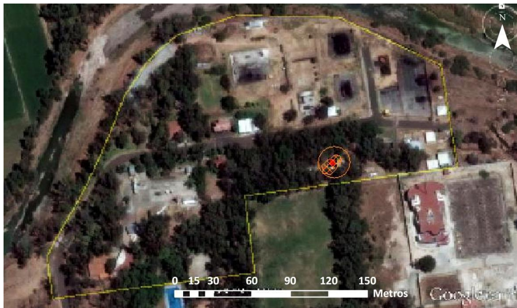
Figura 7.47. Área inflamable por llamarada de Gasolina en condiciones de T_{\min} y H_{R\max} en verano.
