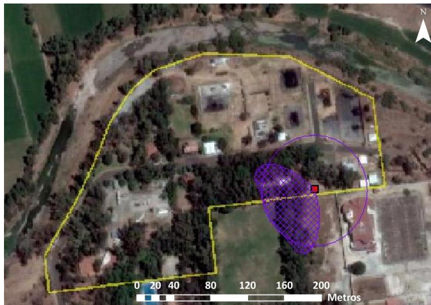
Figura 7.28. Área inflamable en condiciones de T_{\min} y H_{R\max} en otoño, por fuga desde el espacio del líquido.
