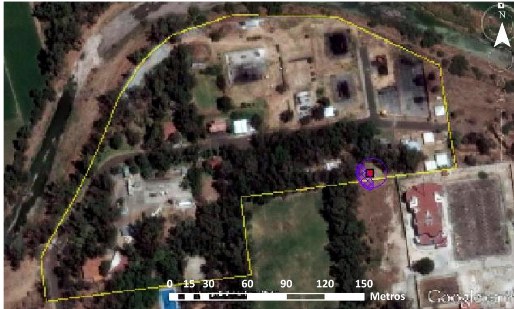
Figura 7.23. Área inflamable en condiciones de T_{m\acute{a}x} y H_{Rm\acute{i}n} en otoño, por fuga desde el espacio de vapor.
