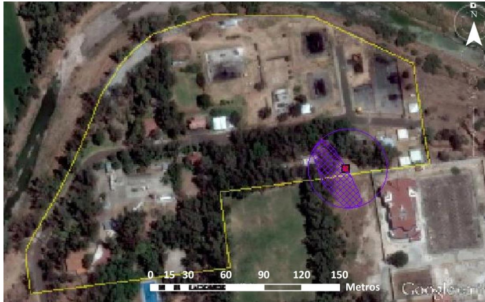
Figura 7.34. Área inflamable en condiciones de T_{m\acute{a}x} y H_{Rm\acute{i}n} en invierno, por fuga desde el espacio del líquido.
