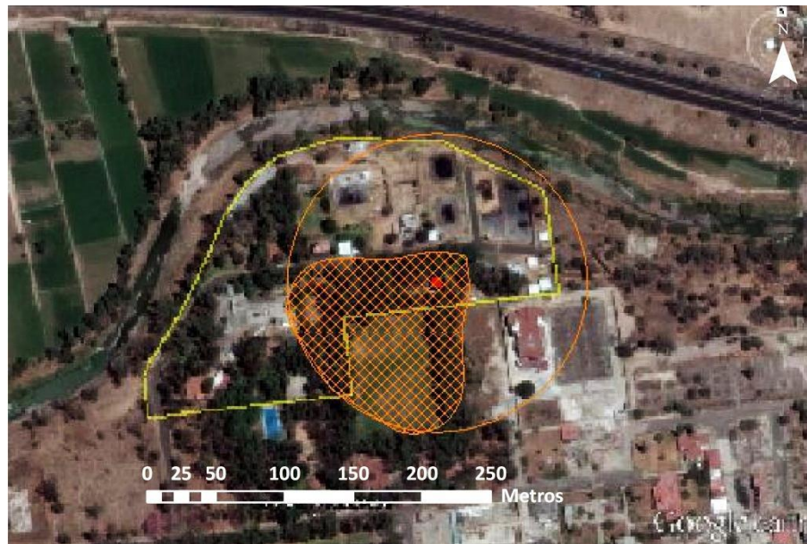
Figura 7.44. Área inflamable por llamarada de Gasolina en condiciones de T_{\text{mín}} y H_{\text{Rmáx}} en otoño.
