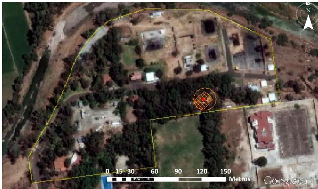
Figura 7.49. Área inflamable por llamarada de Gasolina en condiciones de T_{\text{mín}} y H_{\text{Rmáx}} en invierno.
