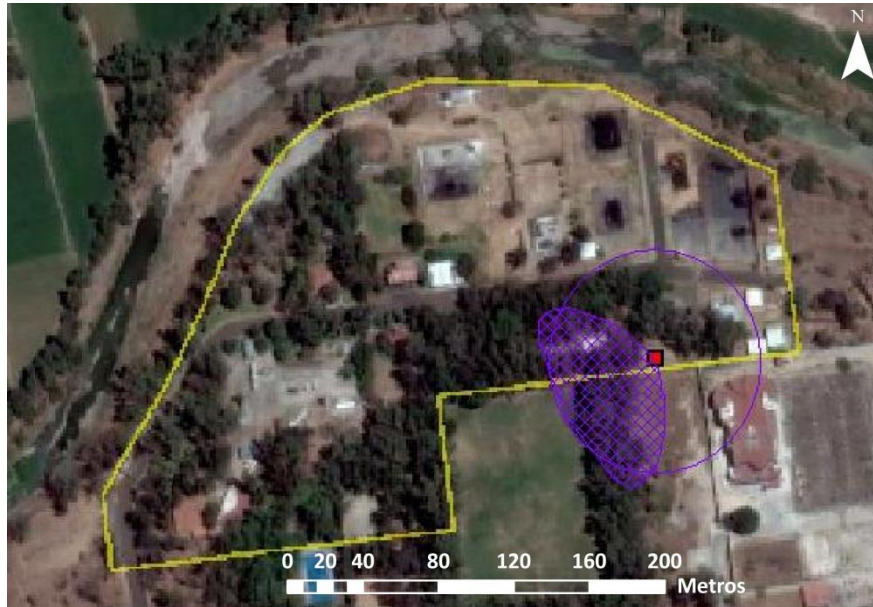
Figura 7.29. Área inflamable en condiciones de T_{\text{mín}} y H_{\text{Rmáx}} en Invierno, por fuga desde el espacio del líquido.
