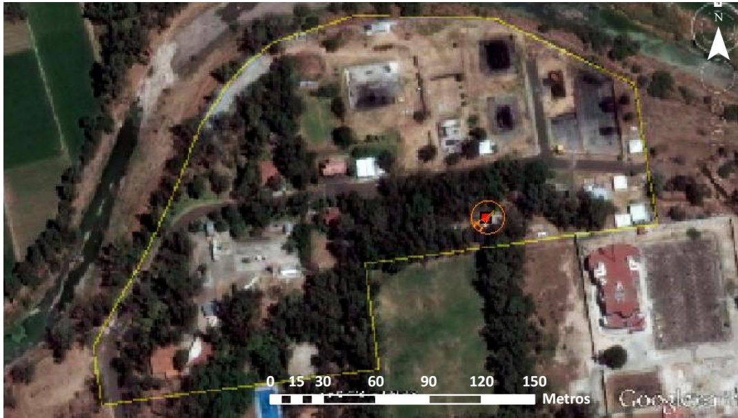
Figura 7.46. Área inflamable por llamarada de Gasolina en condiciones de T_{\min} y H_{R\max} en primavera.
