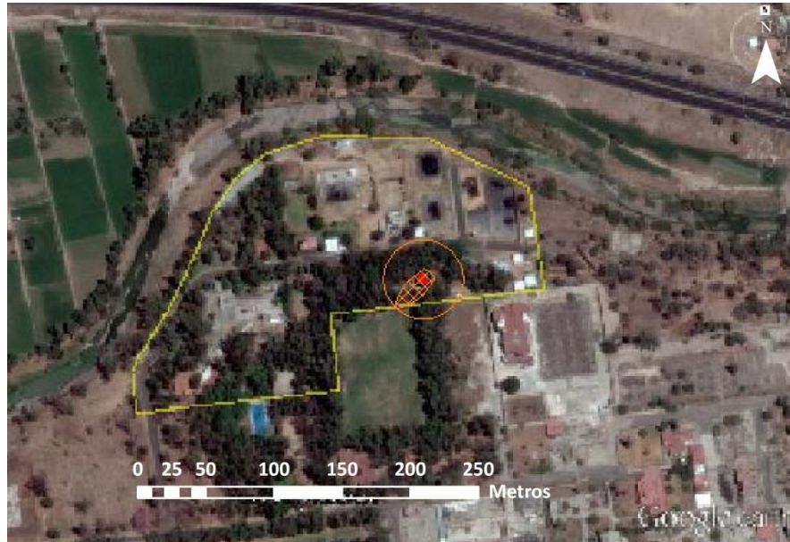
Figura 7.43. Área inflamable por llamarada de Gasolina en condiciones de T_{\text{mín}} y H_{\text{Rmáx}} en verano.
