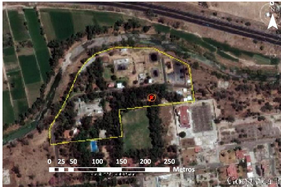
Figura 7.42. Área inflamable por llamarada de Gasolina en condiciones de T_{\text{mín}} y H_{\text{Rmáx}} en primavera.
