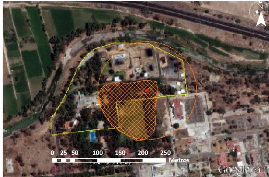
Figura 7.45. Área inflamable por llamarada de Gasolina en condiciones de T_{\min} y H_{R\max} en invierno.
