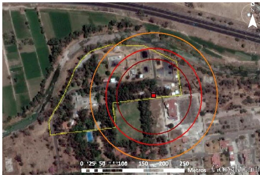
Figura 7.37. Radios de afectación por radiación de la bola de fuego en condiciones de T_{\min} y H_{R\max} .
