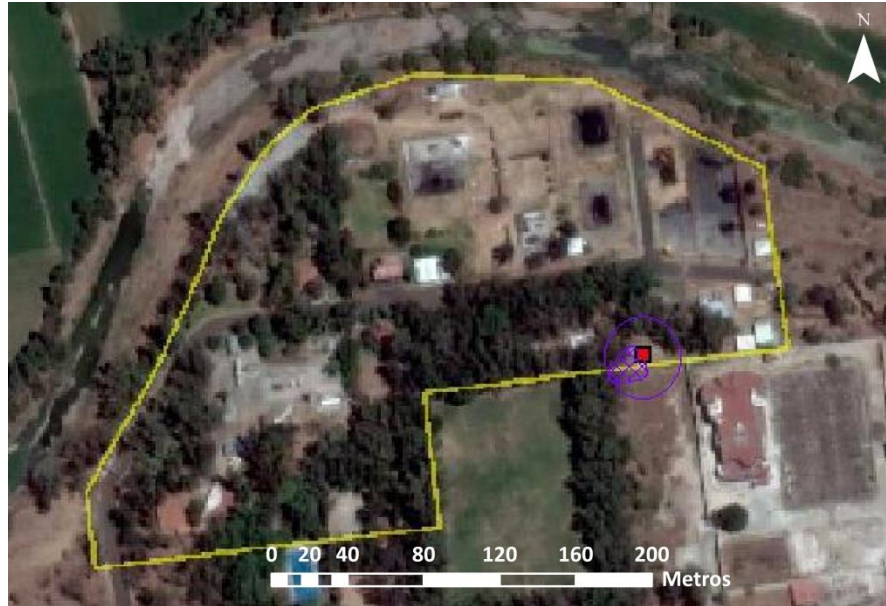
Figura 7.27. Área inflamable en condiciones de T_{\min} y H_{R\max} en verano, por fuga desde el espacio del líquido.
