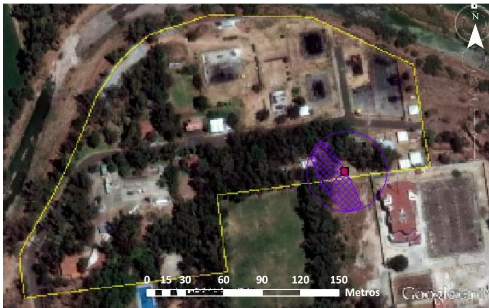
Figura 7.33. Área inflamable en condiciones de T_{\text{máx}} y H_{R\text{mín}} en otoño, por fuga desde el espacio del líquido.
