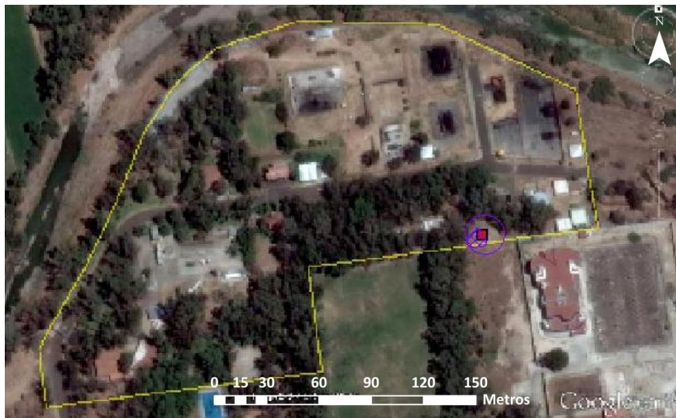
Figura 7.31. Área inflamable en condiciones de T_{\text{máx}} y H_{\text{Rmín}} en primavera, por fuga desde el espacio del líquido.
