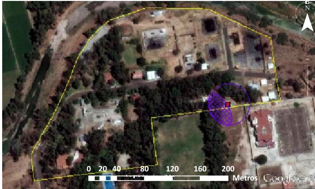
Figura 7.20. Área inflamable en condiciones de T_{\text{mín}} y H_{\text{Rmáx}} en invierno, por fuga desde el espacio de vapor.
