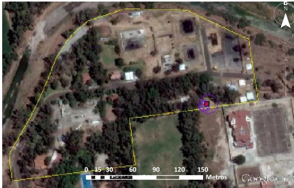
Figura 7.32. Área inflamable en condiciones de T_{\text{máx}} y H_{R\text{mín}} en verano, por fuga desde el espacio del líquido.
