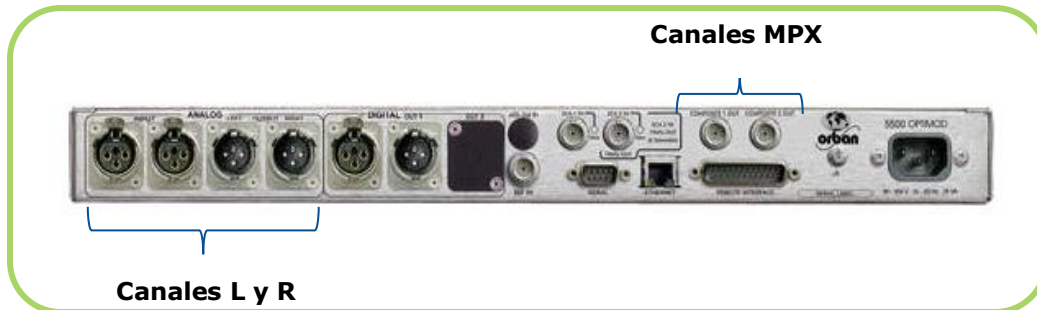
Figura 108. Procesador de audio con canales L, R y canales MPX.
