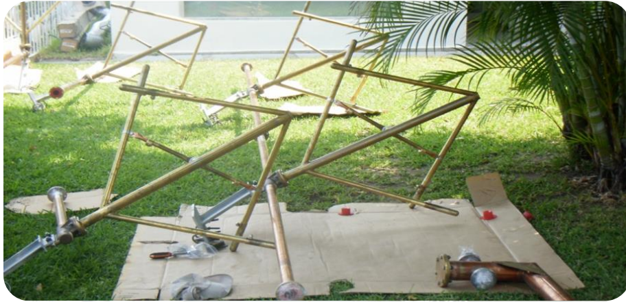
Figura 157. Acoplamiento de las antenas a las líneas rígidas.
