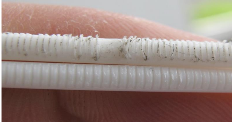
Ilustración 18 Indentación en Filamento
