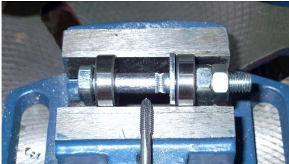
Ilustración 16 Manufactura de Hobbed Bolt con Machuelo
