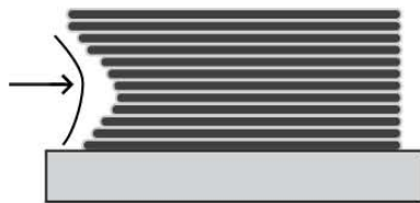
e) Contractura en la parte baja de las piezas
