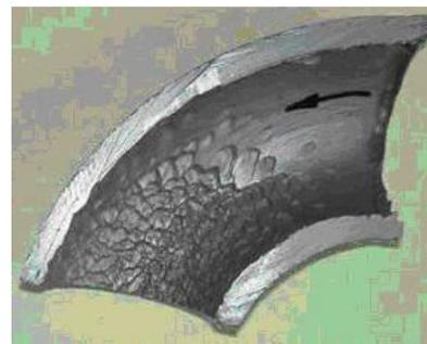
**Figura C.6:** Corrosión por Bisulfuro de Amonio
