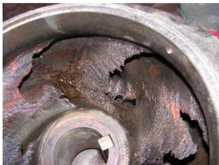
**Figura C.9:** Erosión-corrosión en el rodete de una bomba
