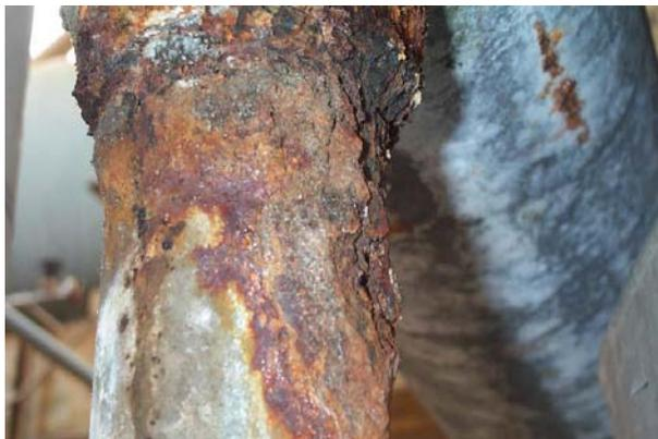
**Figura C.17:** *Corrosión Bajo Aislamiento*
