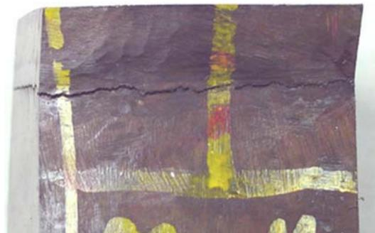
Figura C.15: Falla por recalentamiento
