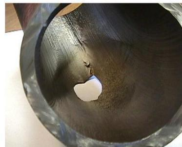
**Figura C.8:** Erosión-corrosión en un codo
