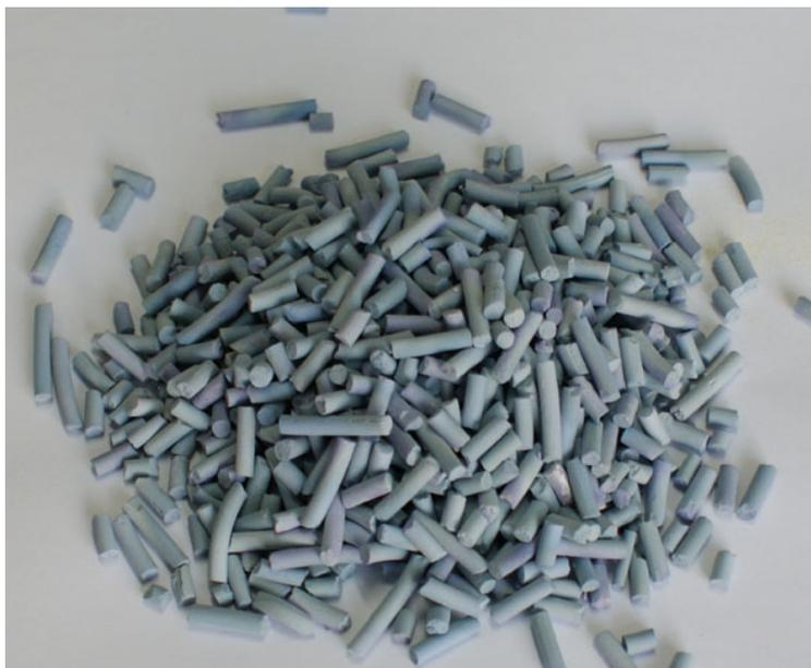
**Figura 2.2:** Catalizador de Co-Mo para hidrodesulfuración.
