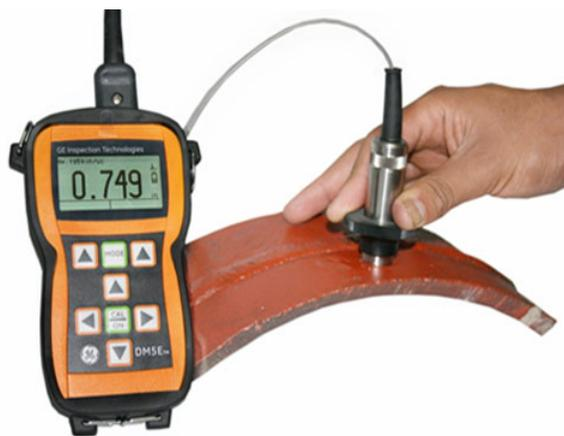
**Figura 3.1:** *Medición de espesor por ultrasonido.*
