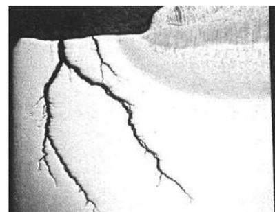
**Figura C.10:** Agrietamiento por amina
