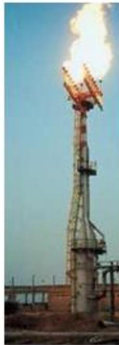
Figura 1.15 Quemador Multipunto en posición elevada <sup>(8)</sup>.
