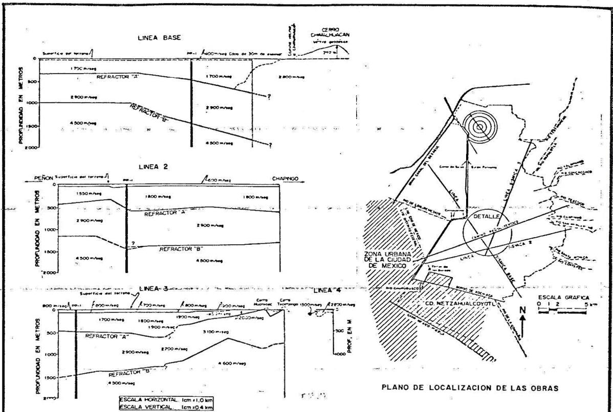
EXPLORACION SISMICA - PERFILES DE REFRACCIONES EN LAS LINEAS 2, 3 Y 4.
