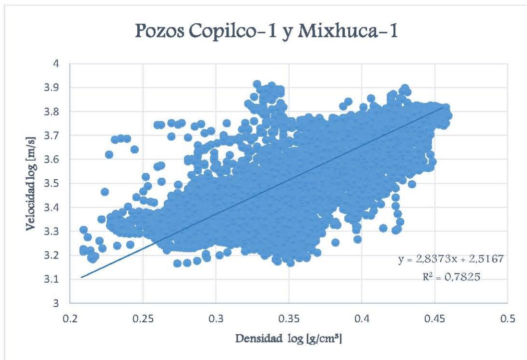
Figura 30. *Crossplot* velocidad vs densidad pozo Copilco-1 y pozo Mixhuca-1 en escala logarítmica.
