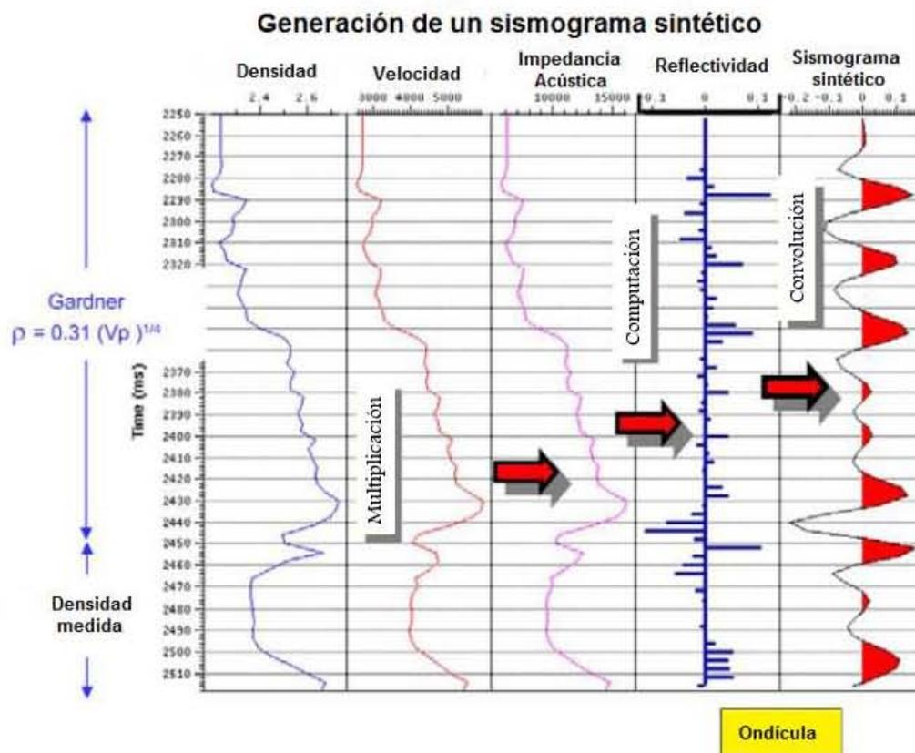
**Figura 18.** Método de construcción de un sismograma sintético. La impedancia acústica se calcula con la simple multiplicación de las curvas de densidad y de velocidad. Subsecuentemente los coeficientes de reflexión se computarizan y se convolucionan con una ondícula sísmica obteniendo así un sismograma sintético. La fórmula de Gardner permite estimar el valor de la densidad para la velocidad logarítmica de la onda P. Modificado de Veeken (2007).
