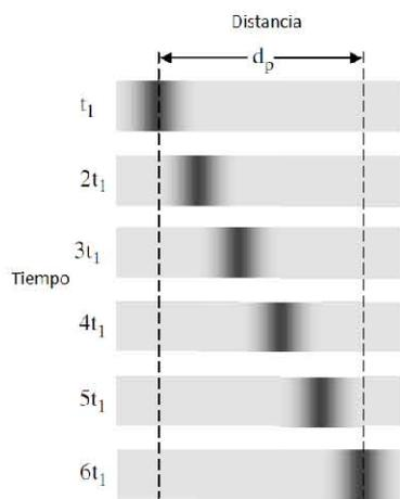
Figura 8. Propagación de la onda P. Figura tomada de Gadallah *et al.* (2009).
