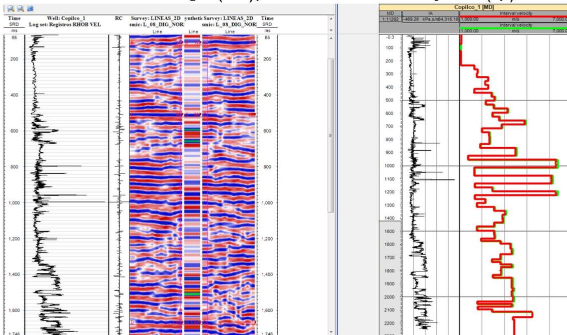
Figura 43. Del lado izquierdo se muestra el sismograma después de la calibración de la curva de velocidad de intervalo, la cual se muestra del lado derecho (roja).
