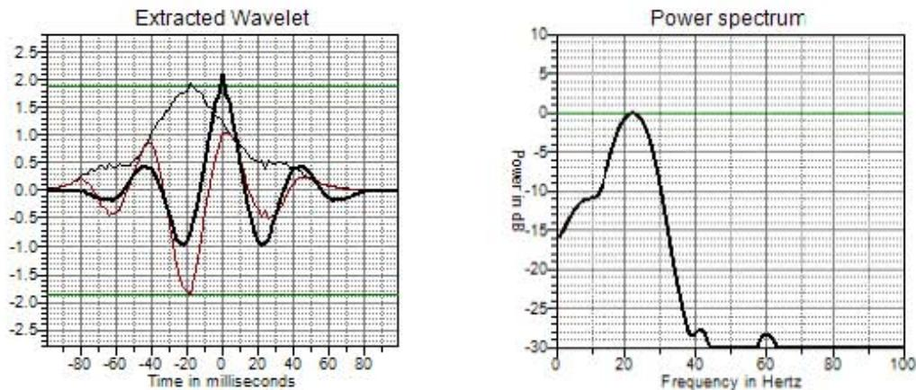
**Figura 39.** Del lado izquierdo se muestra la ondicula extraída de la zona profunda en fase cero y sin desplazamiento; en la derecha el espectro de potencia con una frecuencia predominante de 22 Hz aproximadamente.
