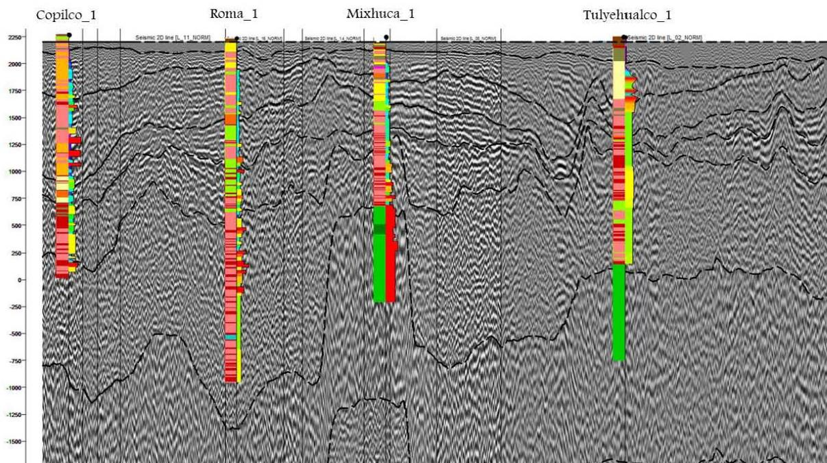
Figura 67. Conversión de sísmica a profundidad. Se observan los horizontes de las capas y se superpusieron las columnas estratigráficas y las curvas  $T-Z$  de cada pozo.
