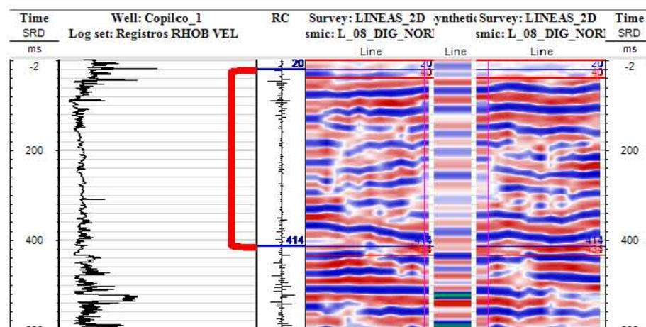
Figura 34. Extracción de la ondícula a partir de la zona somera de la sísmica de reflexión.
