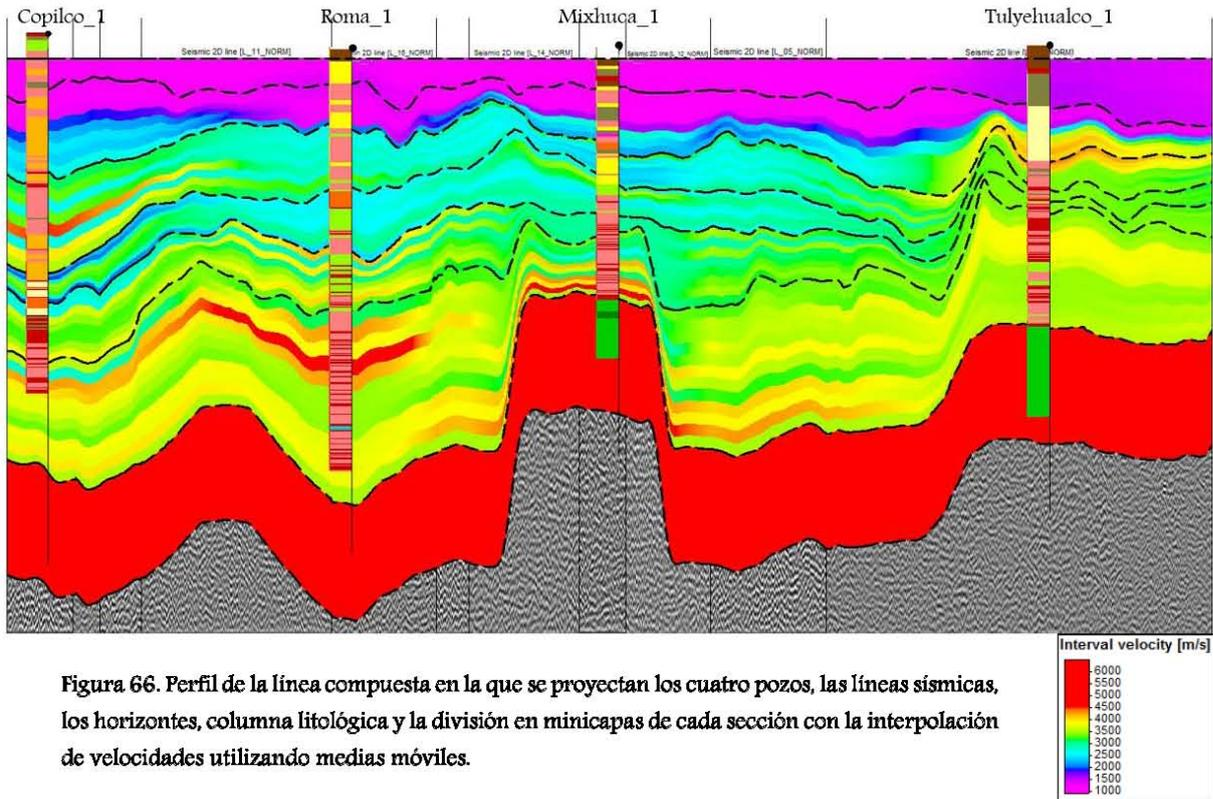
Figura 66. Perfil de la línea compuesta en la que se proyectan los cuatro pozos, las líneas sísmicas, los horizontes, columna litológica y la división en minicapas de cada sección con la interpolación de velocidades utilizando medias móviles.
