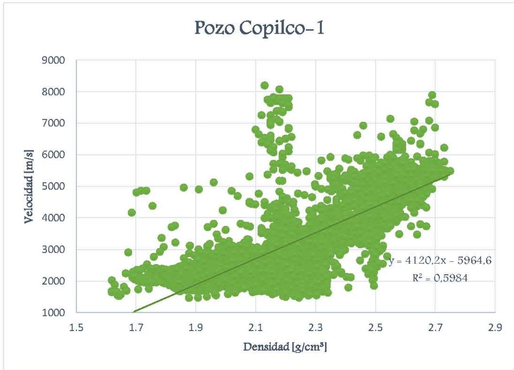
Figura 23. *Crossplot* velocidad vs densidad pozo Copilco-1 en escala lineal.
