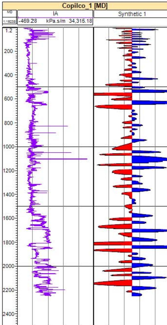
Figura 47. Sismograma sintético obtenido con la ondícula de Eicker.
