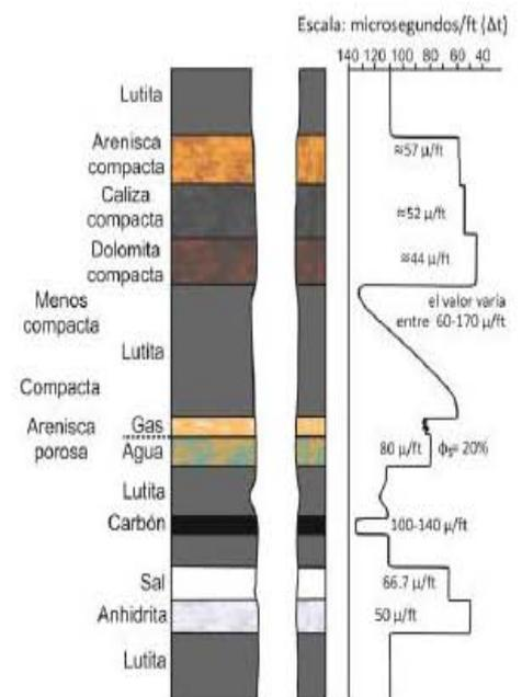
**Figura 17. Respuesta típica que se puede generar en el tiempo de tránsito medido por un registro sínico. Figura tomada de Ricco (2012).**
