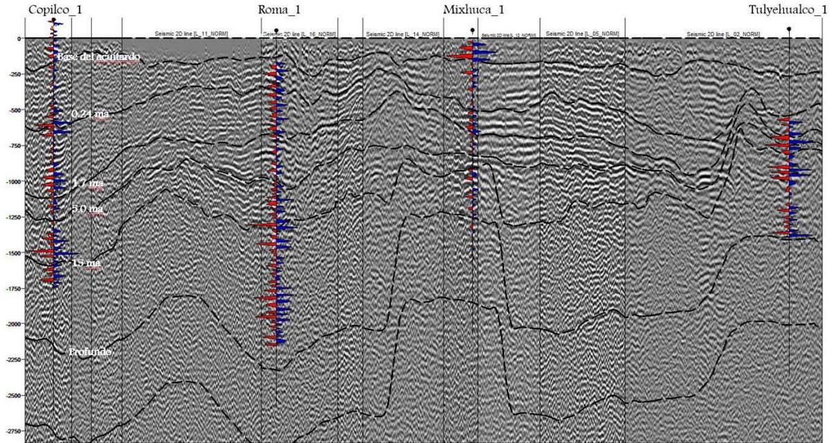
Figura 62. Sismogramas sintéticos generados con la ondícula de Ricker para los cuatro pozos superpuestos en la sísmica de superficie.
