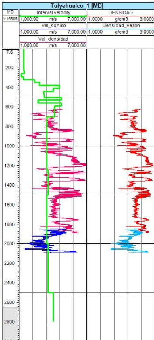
Figura 58. En el carril izquierdo, se muestra el registro sónico original (curva azul), el registro sónico calculado a partir de la densidad (rosa) y el PSV (curva verde), los tres en distintas etapas del pozo. En el carril derecho se muestra el registro de densidad original (curva roja) y el registro de densidad calculado a partir de la velocidad (azul claro).
