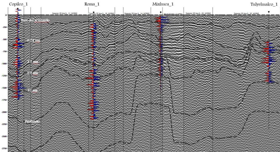
Figura 63. Sismogramas sintéticos generados con la ondícula de Klauder para los cuatro pozos superpuestos en la sísmica de superficie.
