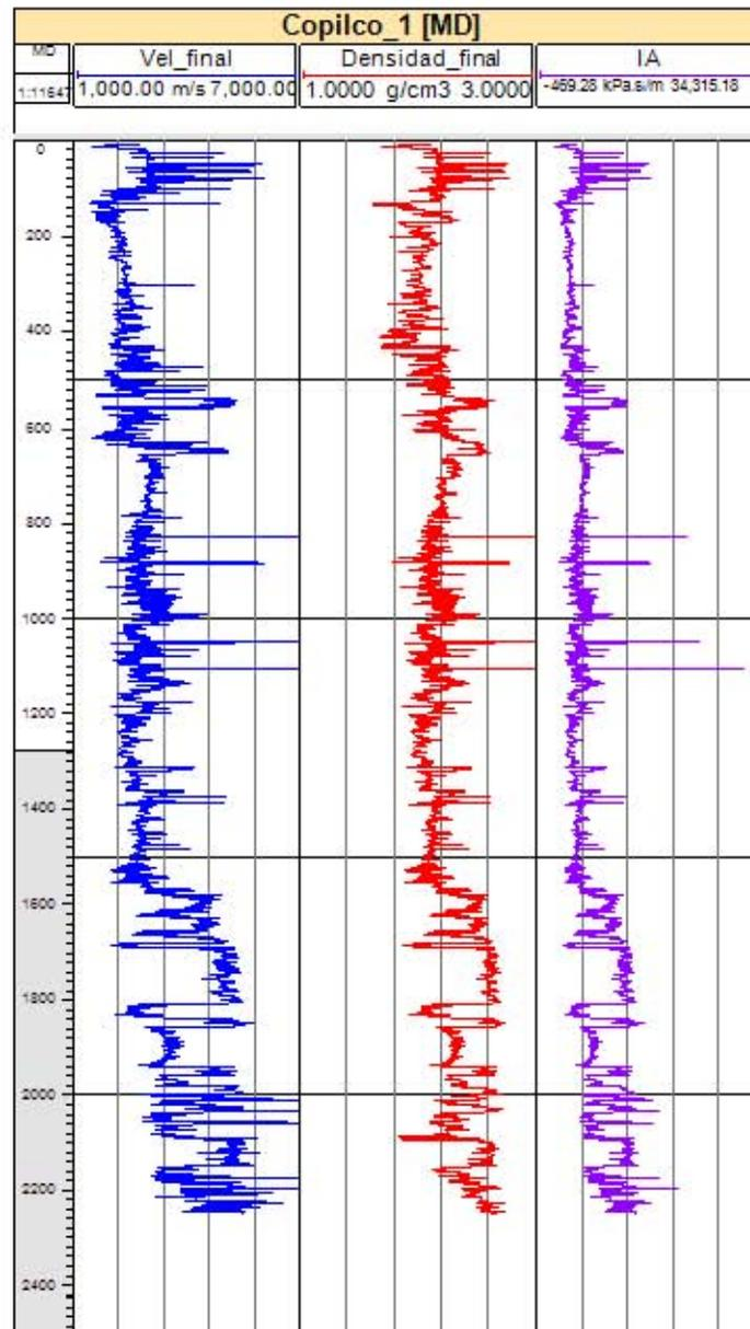
**Figura 33.** En el primer carril se muestra el registro sísmico y en el segundo el registro de densidad, ambos reconstruidos para todo el pozo. La impedancia acústica obtenida multiplicando los registros sísmico y de densidad se muestra en el tercer carril.
