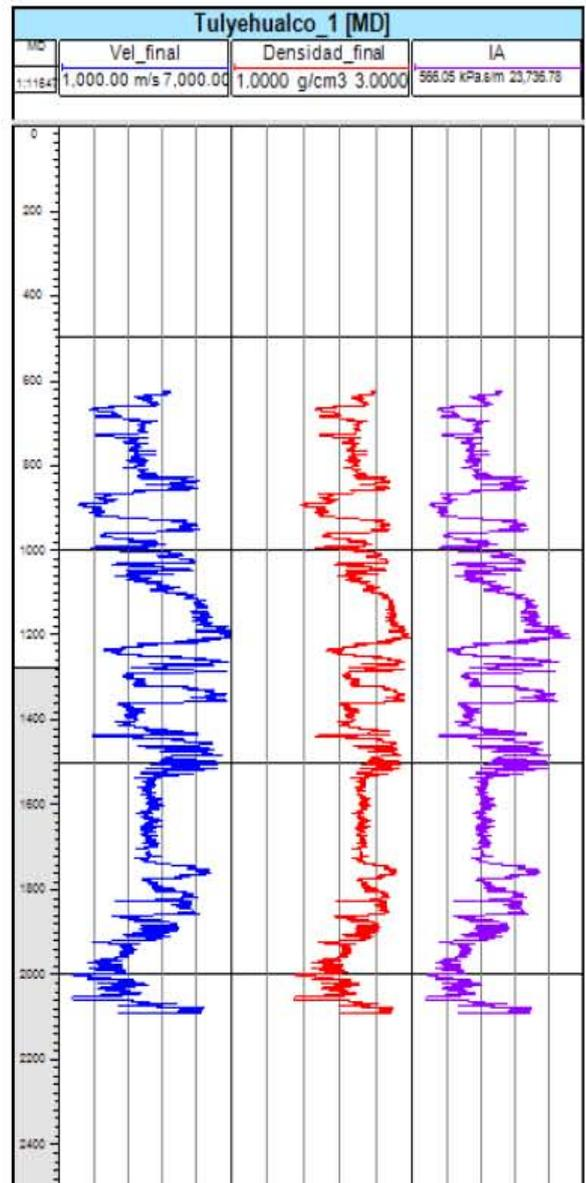
Figura 59. En el primer carril se muestra el registro sónico y en el segundo el registro de densidad, ambos reconstruidos para distintos intervalos. La impedancia acústica obtenida multiplicando los registros sónico y de densidad se muestra en el tercer carril.
