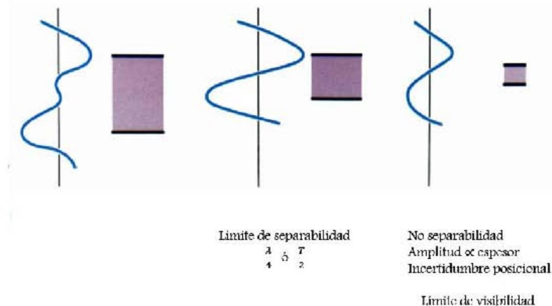
**Figura 19. La resolución de las reflexiones de la cima y de la base de una capa es dependiente del espacio entre ondas. Modificado de Brown (2004).**
