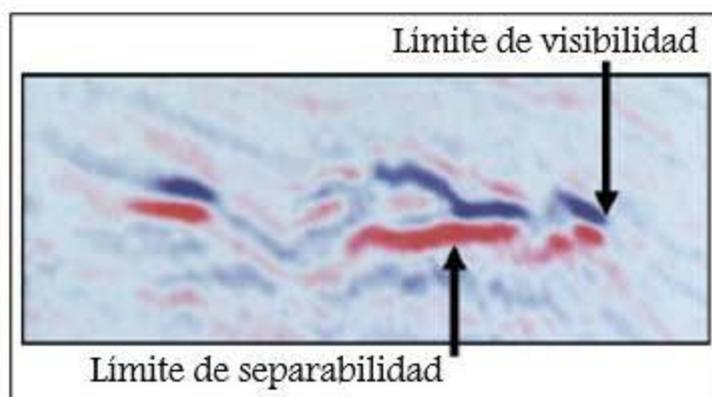
**Figura 20. Demostración del límite de separabilidad y del límite de visibilidad. Modificado Brown (2004).**
