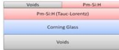
Figura 34. Modelo multicapas propuesto para el modelado de SE.
