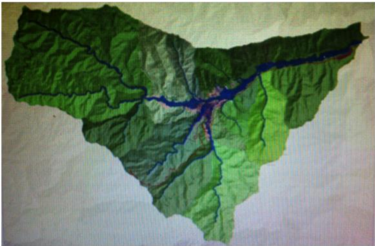
Figura III.2. Escenario de áreas inundables en la cuenca del río Xelajú Grande en el municipio de Motozintla, Chiapas, con una intensidad en la precipitación de 528 mm/hr (Cantarero 2013).
