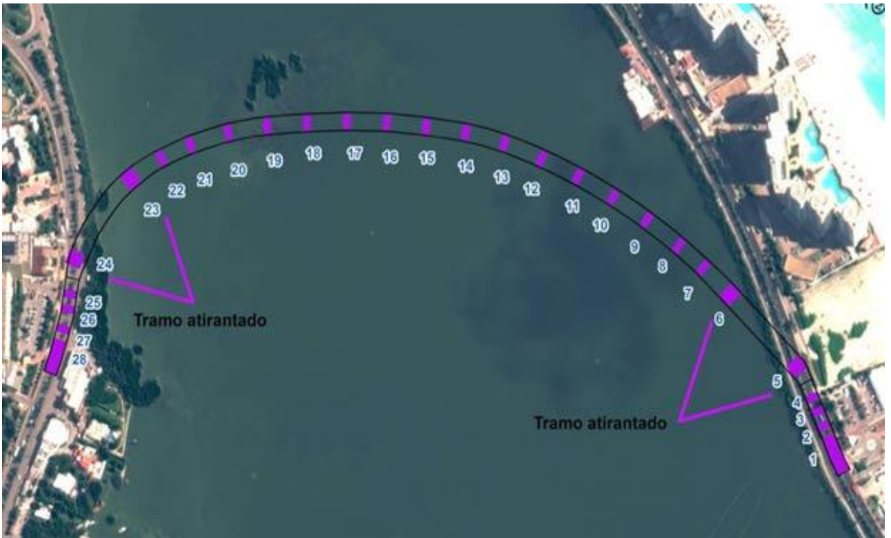
Figura 3.26 Bosquejo del puente en la laguna Nichupté
