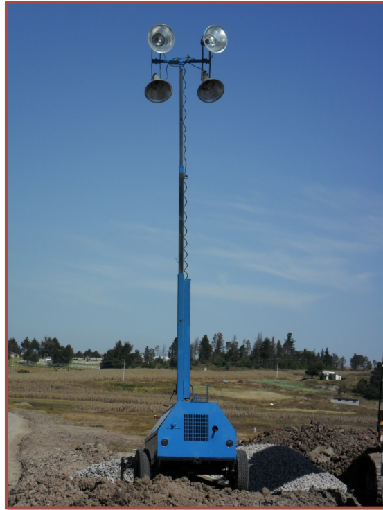
Figura 3.2: Trabajos preliminares: equipo de iluminación (GIT, 2013).
