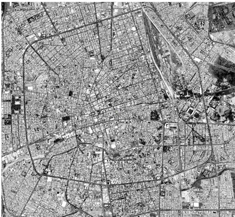
Figura 17. Acercamiento a una imagen Spot 5 pancromática con proceso de ortorectificación.
