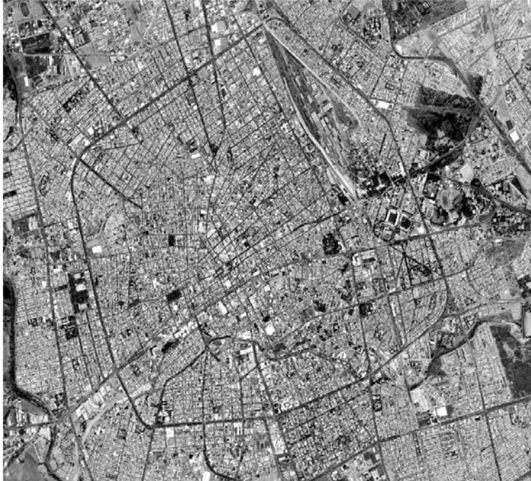
Figura 16. Acercamiento a una imagen Spot 5 pancromática sin proceso de ortorectificación.
