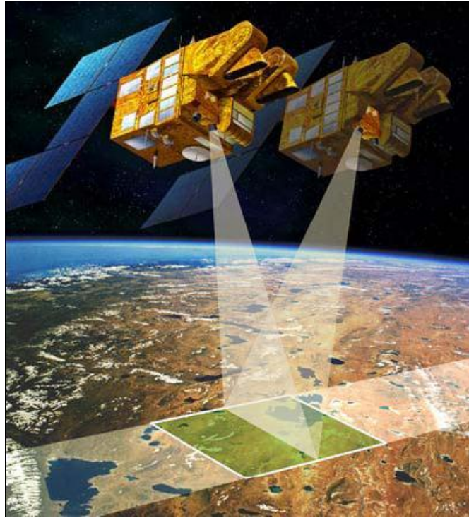
Figura 9. Funcionamiento para la adquisición de pares estereoscópicos con Spot 5. Fuente: Labrador Mauricio. Satélites de teledetección para la gestión del territorio (2012).
