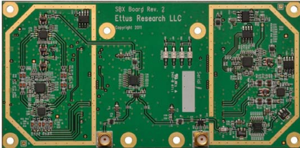
Figura 6.2 – Tarjeta hija SBX de 400 MHz a 4400 MHz.
