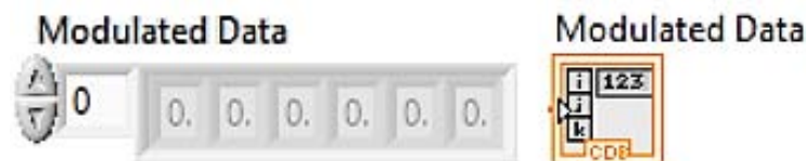
Figura 2.4 – Bloque de un indicador de un arreglo complejo en el panel frontal y en el diagrama a bloques.
