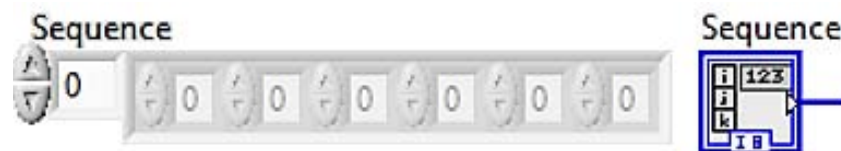
Figura 2.3 – Bloque de un control de un arreglo entero en el panel frontal y en el diagrama a bloques.
