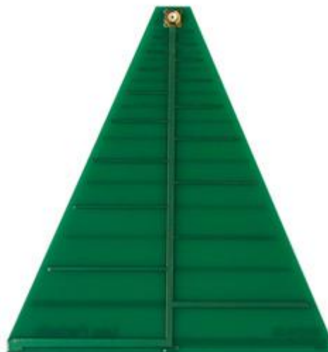
Figura 6.3 – Antena LP0965 de 850 MHz a 6.5 GHz.
