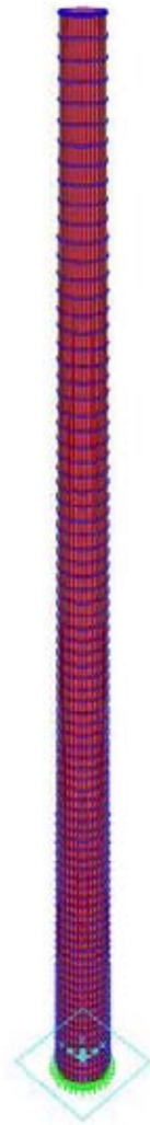
Figura 6-6 Modelo FEM de la torre en el programa SAP2000
