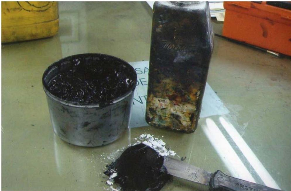
**Paso 2.** Posteriormente, la tinta *offset* se prepara con una medida de carbonato de calcio y se diluye. Este es un proceso muy conocido en los talleres de *offset*.
