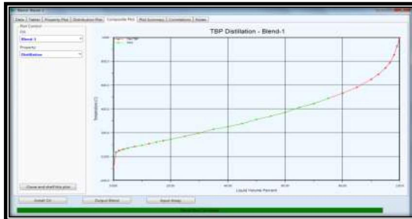
Figura 4.6 Curva TBP calculada con el Blend
