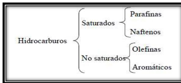
Figura 2.1 Tipos de hidrocarburos
