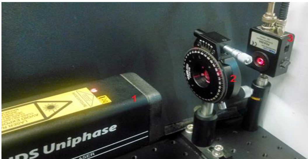
Figura 6.9. Instalación montada para analizar el estado de polarización de la luz a la salida del láser. (1) Láser, (2) Base giratoria con polarizador lineal, (3) Fotoreceptor.
