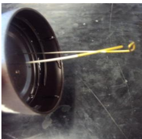
4. Alambres cubierto con la capa de óxido
