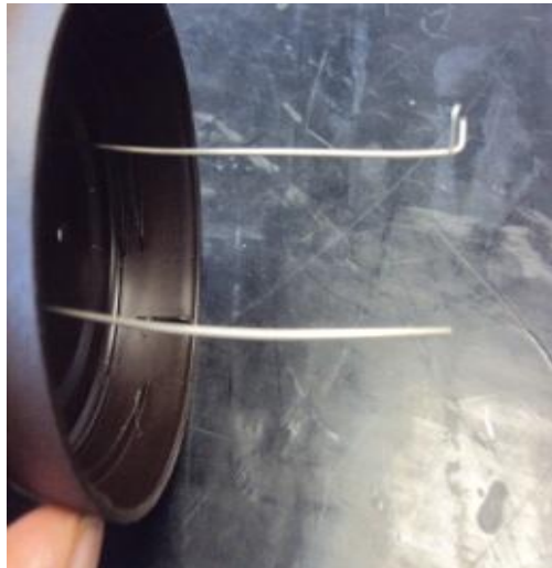
2. Se sumergió solo una parte de los alambres para crear la capa de oxidó
