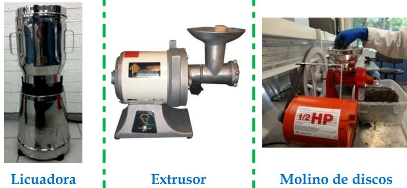
Figura 5.2. Equipos utilizados en la trituration de la FORSU
