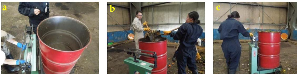
**Figura A.2.** Procedimiento para la determinación del peso volumétrico de los residuos muestreados
