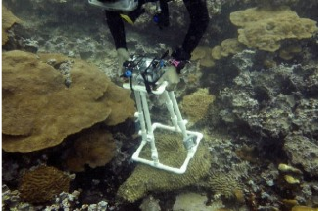
Figura 10. Método del fotocuadrante para el muestreo de reclutamiento coralino y la cobertura de los gremios algales.
