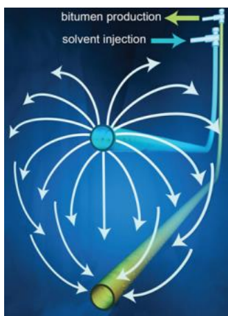
Figura 153 Arreglo de tecnología BEST (Bitumen Extraction Solvent Technology). (Braswell, 2012)
