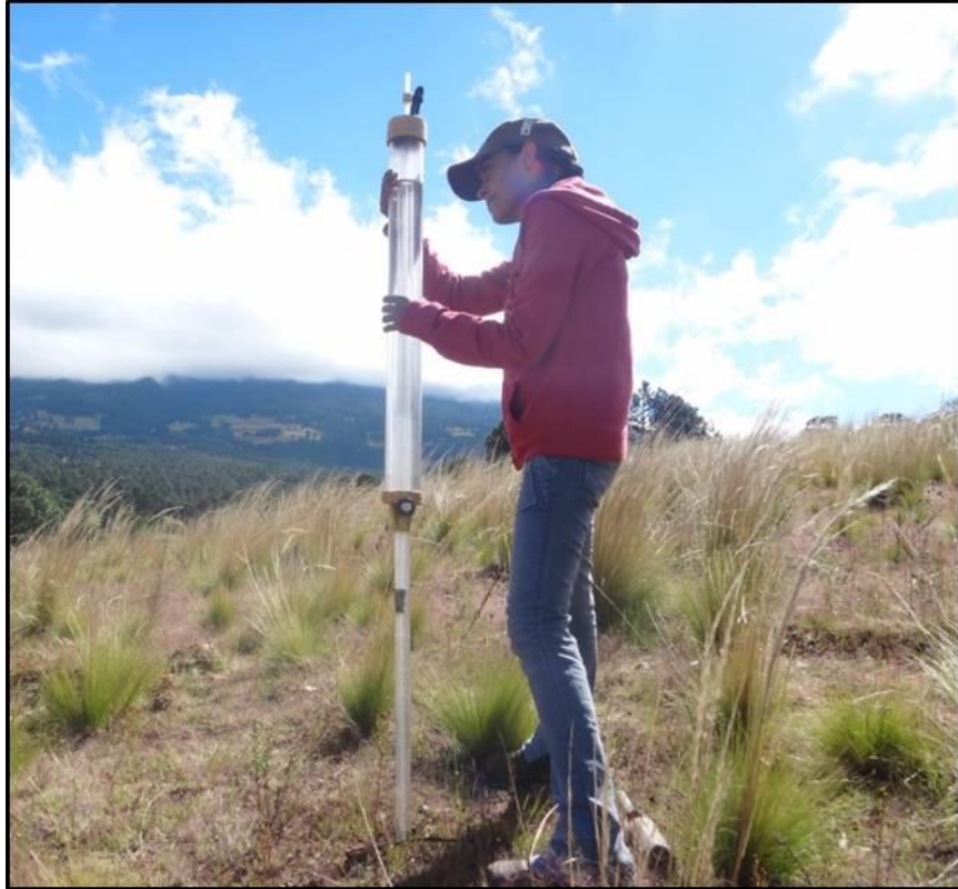
Figura 8. Evaluación de las propiedades hídricas con permeámetro Guelph en el Parque Nacional Cofre de Perote.
