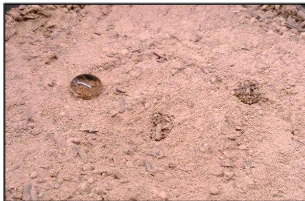
Figura 9. Evaluación de hidrofobicidad con método WDPT en campo.
