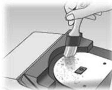
Figura 14. Limpieza de la termobalanza <sup>24</sup>.
