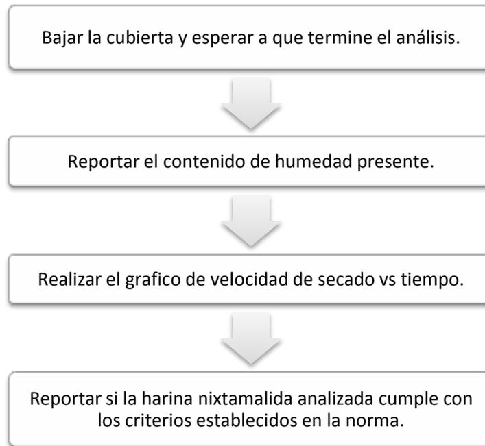
Figura 6. Diagrama de bloques del procedimiento experimental seguido para el subtema "Termobalanza"
