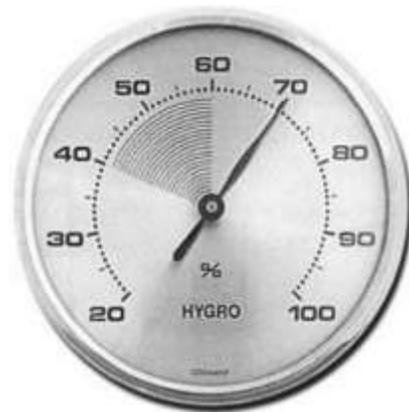
Figura 27. Higrómetro de cabello <sup>31</sup>.
