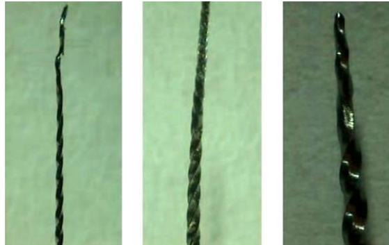
Fig. 23 Defectos en limas K-file #10 y #15 y lima rotatoria ProTaper después de un solo uso
