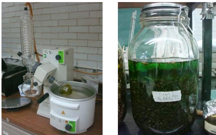
Figura 6. Destilación a presión reducida y macerado de las hojas de Zinnia peruviana .
