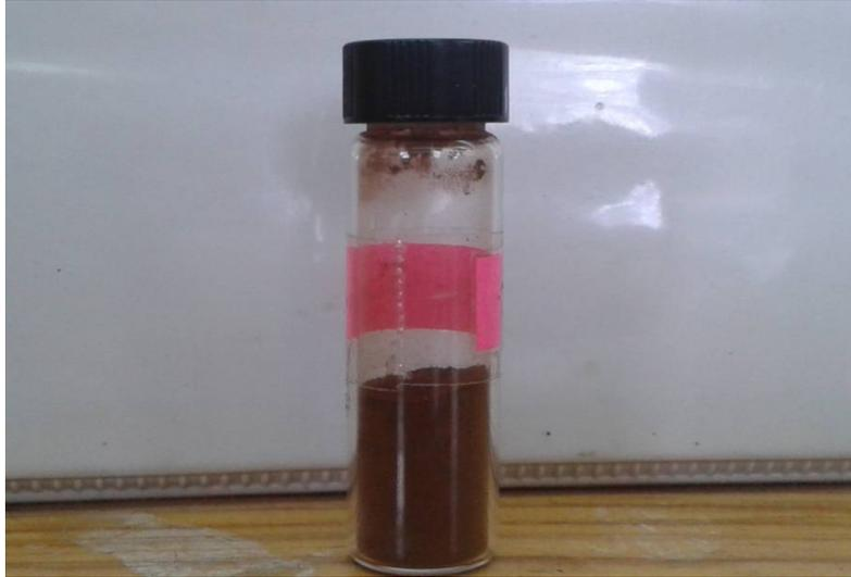
Figura 4.1. Polvo de Ferrita de Níquel, obtenido por hidrólisis forzada en poliol.
