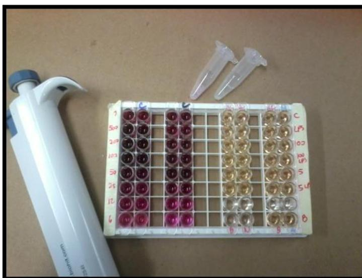
**Fig.10.** Microplaca que ejemplifica el ensayo colorimétrico de Griess para detectar NO.
