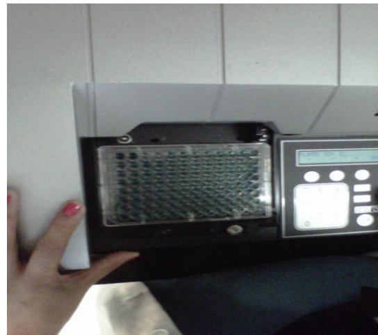
Figura 7. Espectrofotómetro para lectura del ELISA (Fotografía de: G. Anduaga R.)
