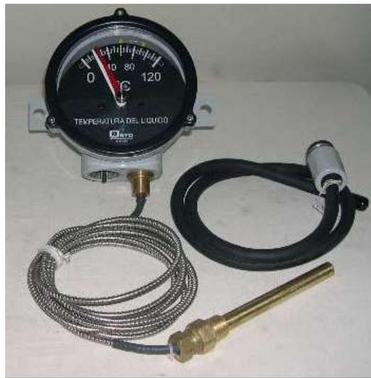
**Figura 2.1 Indicador de temperatura del aceite.**
