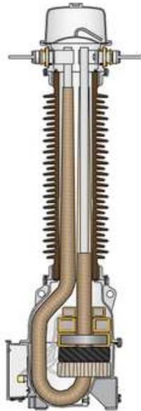
**Figura 1.15 Transformador de corriente (T.C.).**
