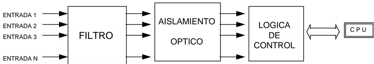
**Figura 4.3 Diagrama a bloques de un Módulo de Entradas Digitales.**
