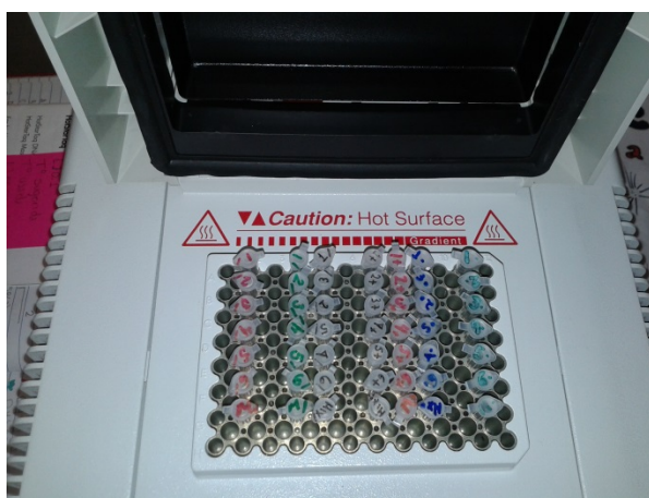
Figura 11. Corrida de PCR en un Mastercycle gradient Eppendorf.
