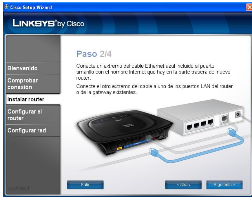
Figura 3.27 Conexión del Ethernet al Router
