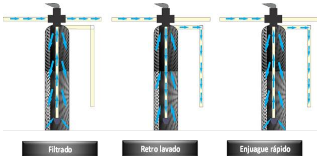
Figura 47. Muestra la operación filtrado, retrolavado y enjuague rápido del filtro FC-01.
