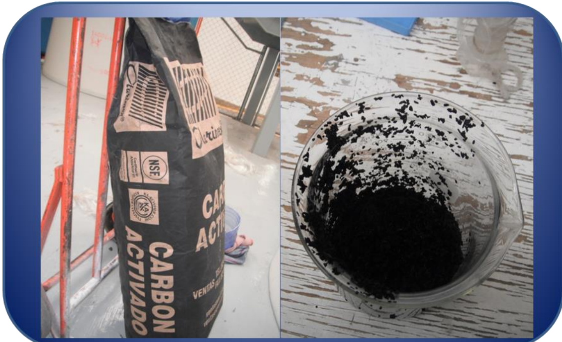
Figura 61. Muestra el carbón activado nuevo que se colocó en los filtros FC-01.
