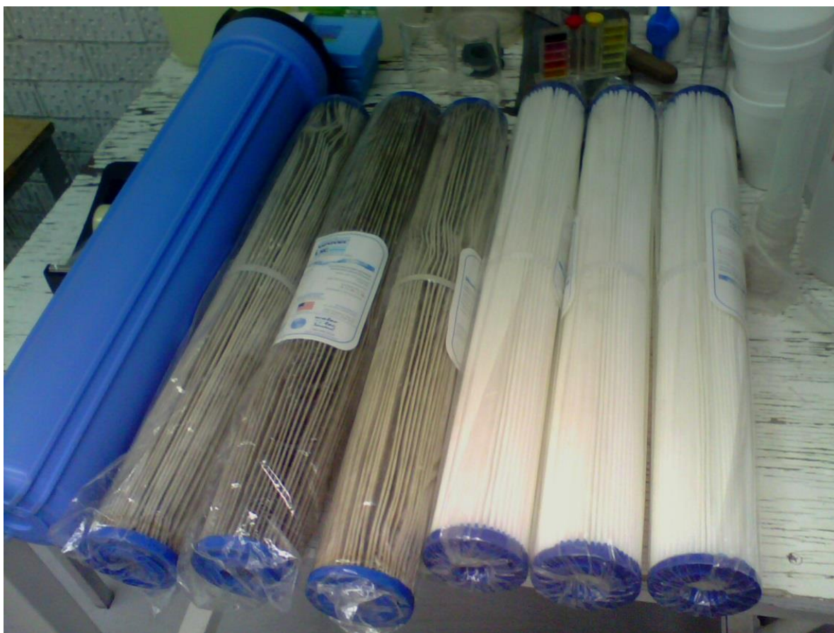
Figura 48. Muestra la carcasa, los cartuchos usados y nuevos de los filtros pulidores.
