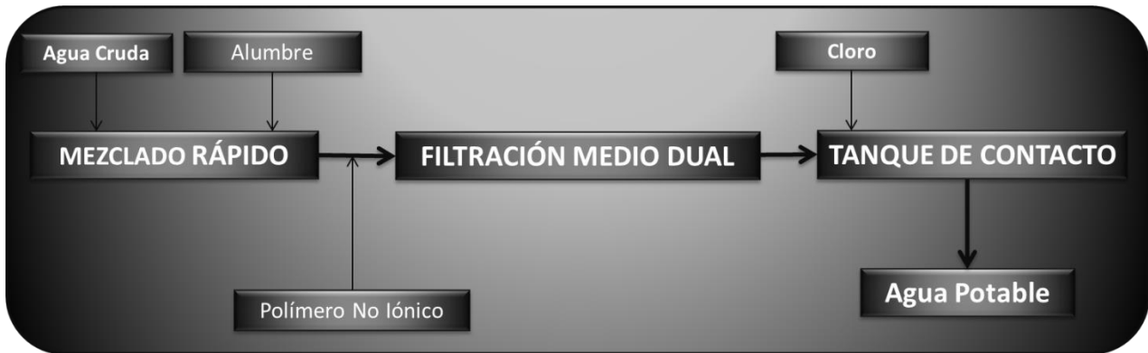
Figura 10. Planta de filtración directa (10) .
