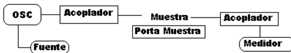
Figura. A.5.5 Diagrama de bloques de un equipo de microondas.
