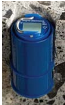
Figura 2.7 Fotografía del elemento que se incrusta en el concreto para obtener la información
