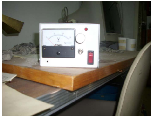
Figura A.2.4. Fotografía del frente del reflectómetro diseñado y desarrollado para su aplicación en las pruebas sobre concreto.
