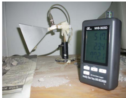
Figura.4.31. Fotografía del hidrotérmetro en la mesa de pruebas del laboratorio.
