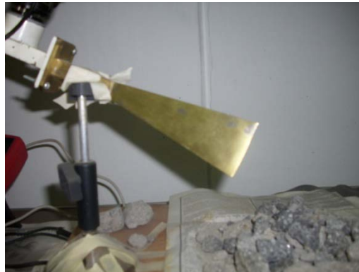
Figura 3.6 Fotografía de uno de los sensores utilizados en el laboratorio para aplicar la señal de microondas sobre la muestra de concreto fresco.
