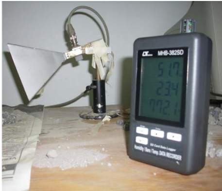
Figura 4.16. Instrumento utilizado para conocer las condiciones de temperatura y humedad del medio en el que se realizaron las pruebas.
