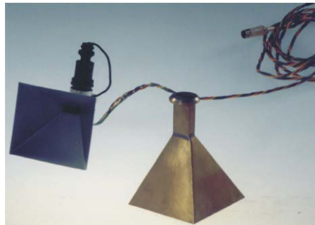
Figura A.2.5. Fotografía de un par de antenas piramidales o de corneta
