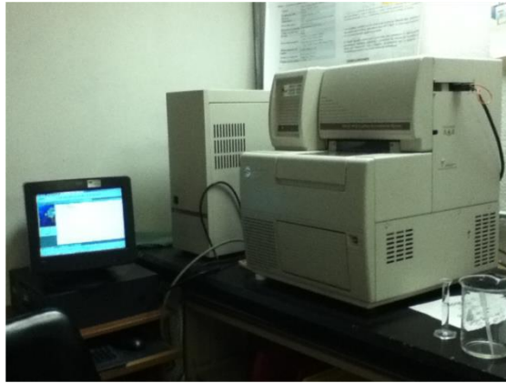
Figura 11. Equipo de electroforesis capilar Beckman Coulter P/ACE MDQ
