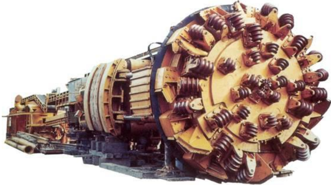
Fig.18. Máquinas con cinceles rodantes montados en la cabeza
