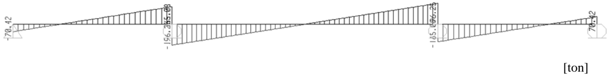
Figura 5.4 Diagrama de fuerza cortante, carga muerta
