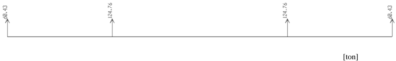
Figura 5.10 Reacciones obtenidas en SAP 2000
