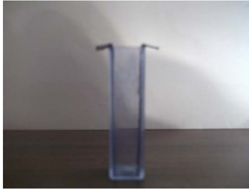
Figura 5-2 Condensador utilizado en las mediciones construido a partir de una celda espectrofotométrica
