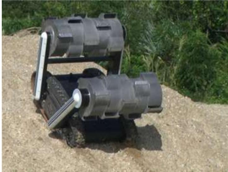
Imagen 5.41. Mecanismo de cilindro giratorio.
