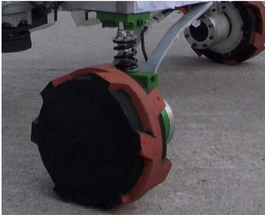
*Imagen5.30. Suspensión acoplada al rover.*
