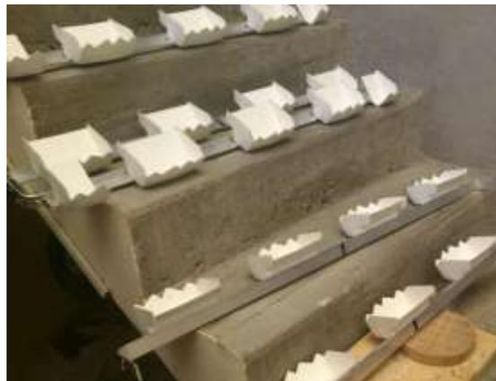
Imagen5.52. Ensamble de los cangilones en el perfil "T" (superior); perfiles con cangilones manufacturados (inferior).
