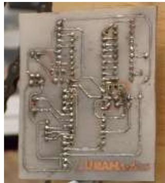
Imagen 4.4. Prototipo de la tarjeta controladora de motores.
