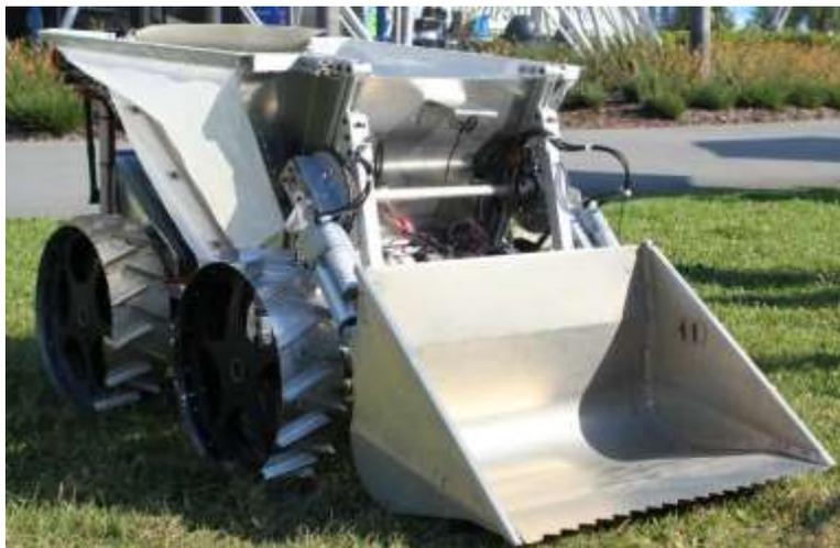
Imagen 3.20. Robot de excavación de la Universidad de West Virginia
