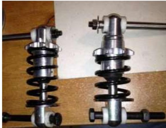
*Imagen5.29. Comparación de resortes usados en la suspensión.*
