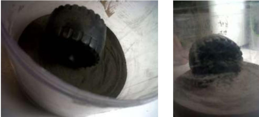
Imagen 4.5. Prueba de llantas en el simulante lunar.
