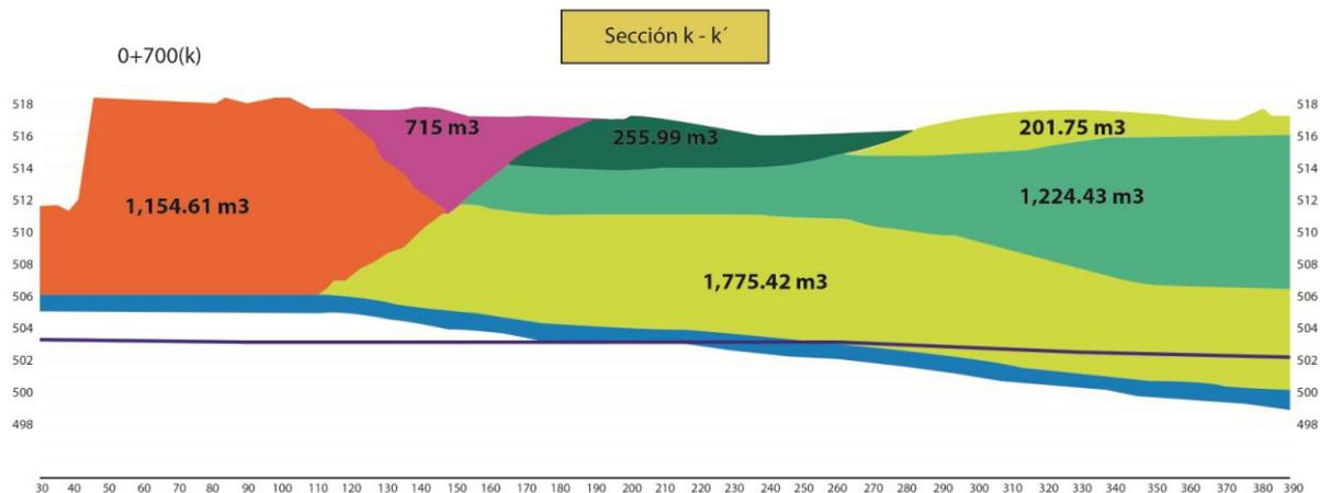
Figura 6.1. Cortes estratigráficos para determinar volumetría de los distintos materiales en el sitio
