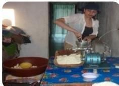
Paso 8: Molino, los pedazos cortados de la cuajada se muelen en un molino eléctrico, el tamaño de corte de la cuajada puede variar al tamaño del molino.
