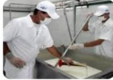
Paso 2: La leche pesa a un tanque de acero inoxidable para conocer la cantidad que entrará a proceso para pasteurizarla, calentar la leche a una temperatura de 65°C por 30 minutos, para eliminar los microorganismos patógenos y mantener las propiedades nutricionales de la leche, para luego producir un queso de buena calidad. La leche pasteurizada se enfría a una temperatura de 37-39 C, pasando agua fría en con hielos.
