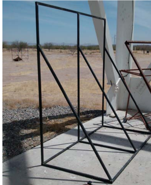
Figura 3.14: Estructura creada para soportar el target .
