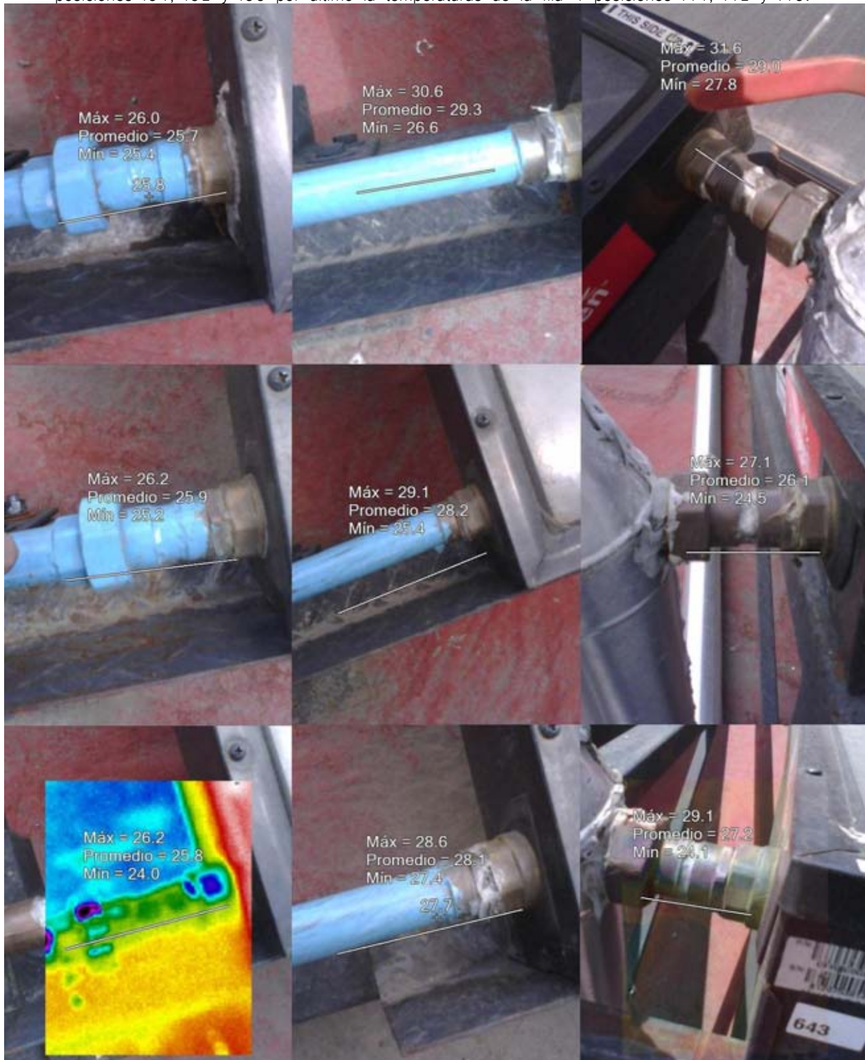
Figura 35. Imágenes termograficas de las fila 2, 3 y 4, las tres imágenes de la fila superior corresponden a temperaturas fila 2, f21, f22 y f23, el siguiente renglón muestra temperaturas fila 3, posiciones f31, f32 y f33 por último la temperaturas de la fila 4 posiciones f41, f42 y f43.
