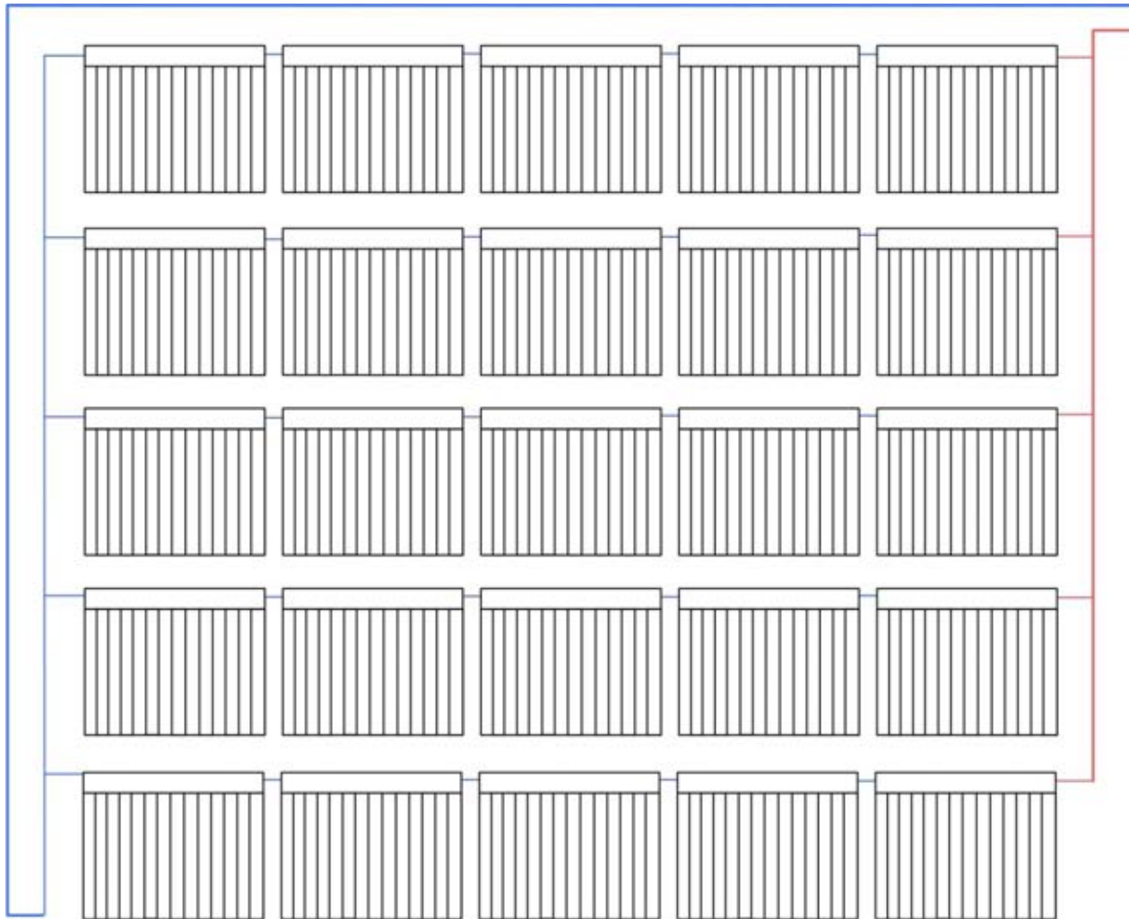
Figura 70. Conexión propuesta de los colectores heat pipe
