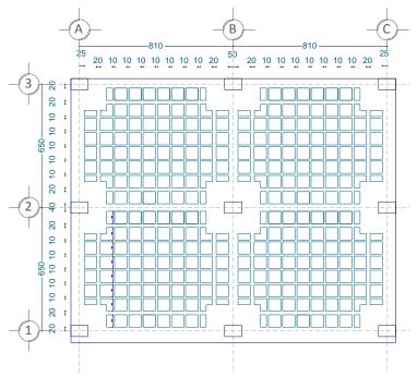
Figura III-2 Distribución de casetones para el ejemplo EJ-1
