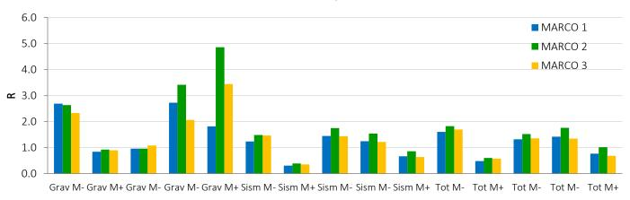
Figura IV-6 Relación MNTC/MMAN por condición de análisis. Ejemplo EJ-2
