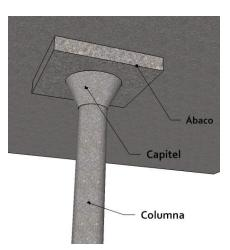
**Figura I-8** Detalle de capitel y ábaco en columna circular.
