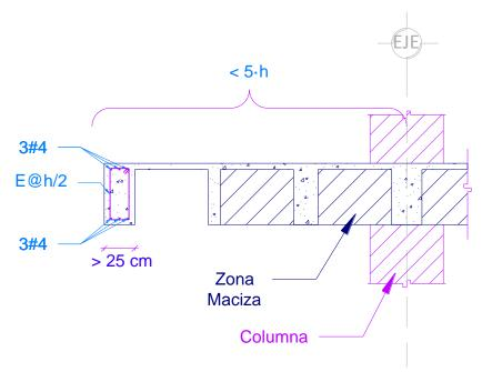
Figura II-2 Recomendaciones para borde de losa plana aligerada.
