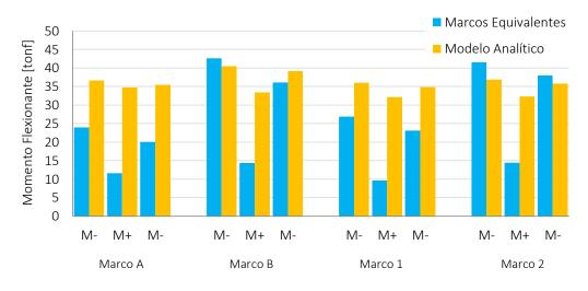
Figura IV-1 Gráfica de momentos marco equivalente vs. Modelo analítico. Ejemplo Ej-1
