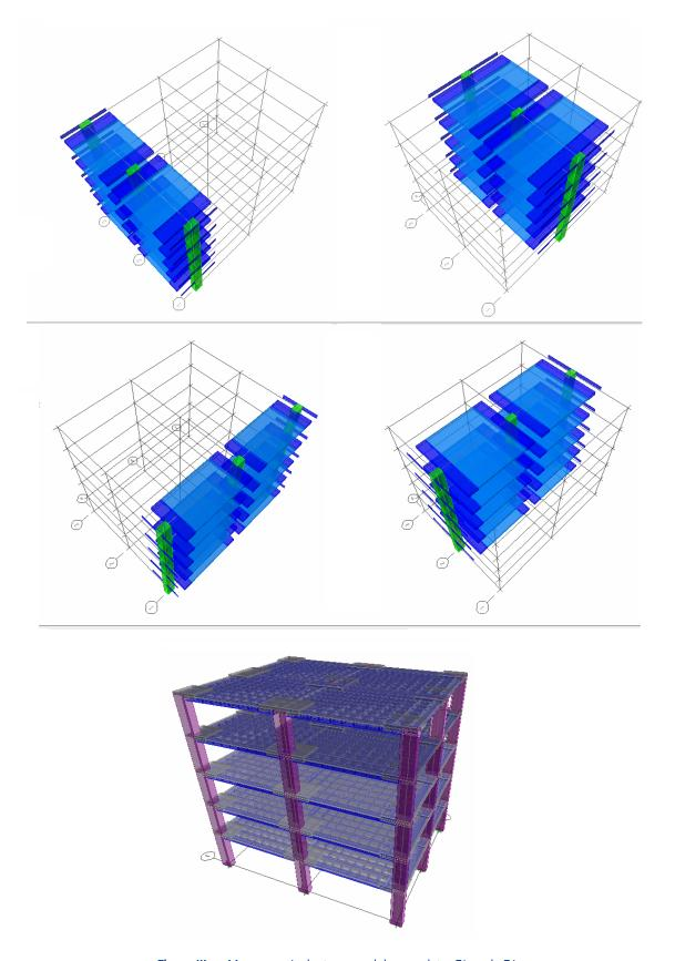
Figura III-14 Marcos equivalentes y modelo completo. Ejemplo EJ-1
