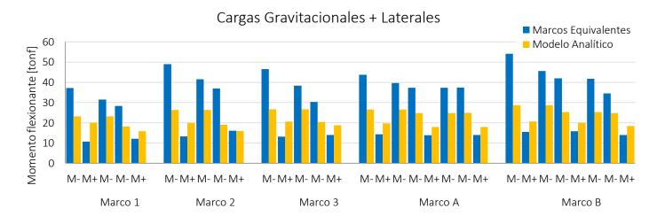
Figura IV-5 Gráfica de momentos Marco Equivalente vs. Modelo Analítico. Ejemplo Ej-2
