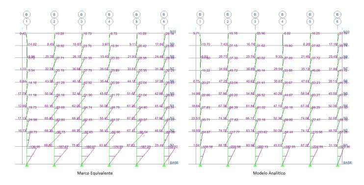
Figura IV-9 Momentos flexionantes en columnas. Ejemplo Ej-2
