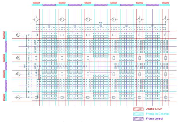
Figura III-16 División para el análisis por marcos equivalentes. Ejemplo EJ-2
