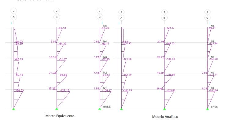
Figura IV-8 Momentos flexionantes en columnas Ejemplo EJ-1
