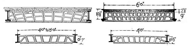
Figura I-3 Sistemas de piso de arcos planos hechos con bloques de cemento, típicos a finales del siglo XIX y principios del XX
