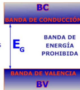
Figura 3.2. Banda de energía prohibida (bandgap) en los materiales.
